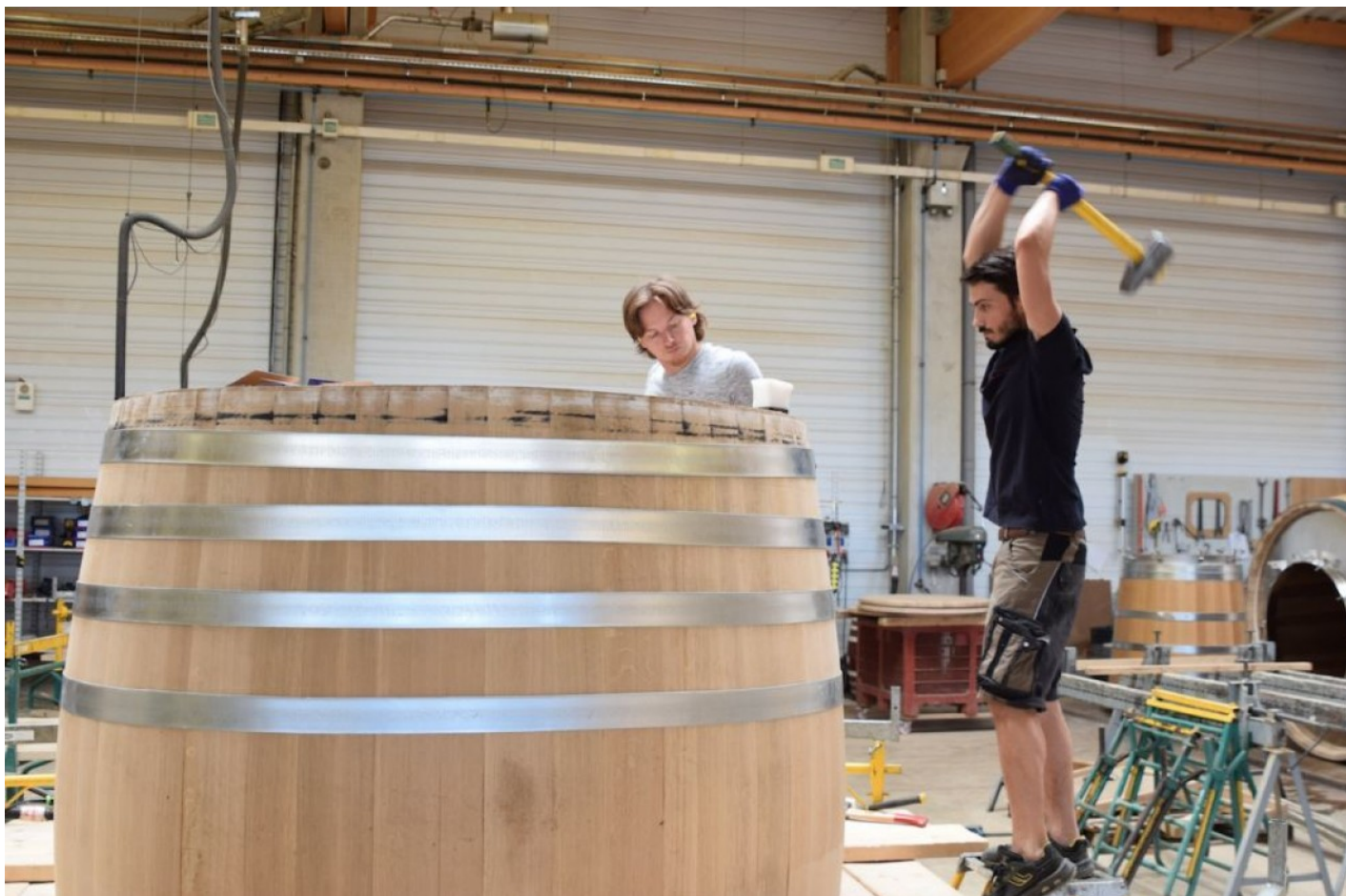
Cerclage d'un grand contenant sur le site de Gevrey-Chambertin (Côte-d'Or). © Traces Ecrites
