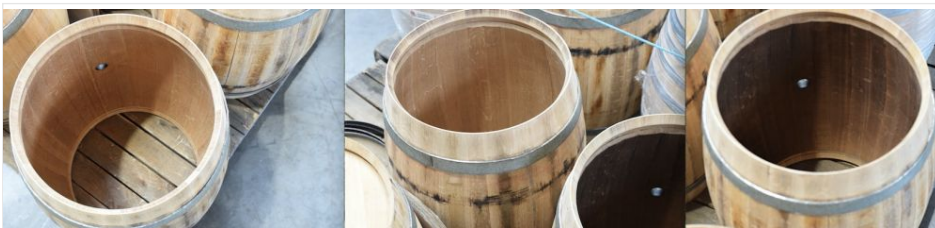
Différentes chaufes de l'intérieur d'un tonneau selon la volonté du vigneron. La tendance actuelle est aux cuissons légères (à gauche). © Traces Ecrites
